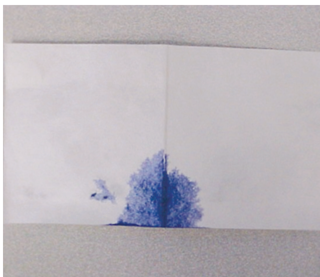
Рис. 50. Просачивание происходит, когда краситель слишком долго находится в конверте во время тестирования по ASTM F1929:2003
