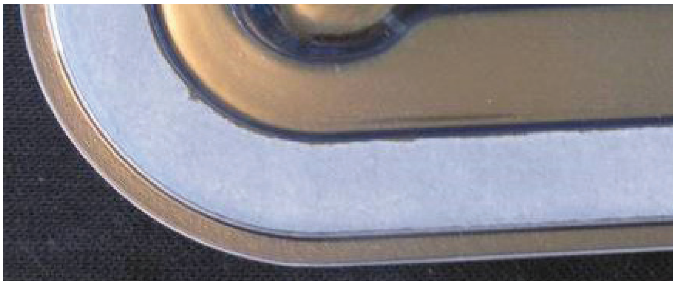
Рис. 53. Прогнозирование разрыва волокон на основании расположения крышки на лотке
