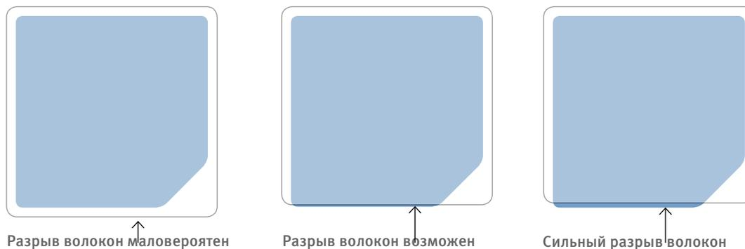
Рисунок 17. Прогнозирование разрыва волокон на основании расположения крышки на лотке.
